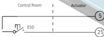
Gbr 6-11 ESD control of non zero voltatge for DC24V from the actuator
